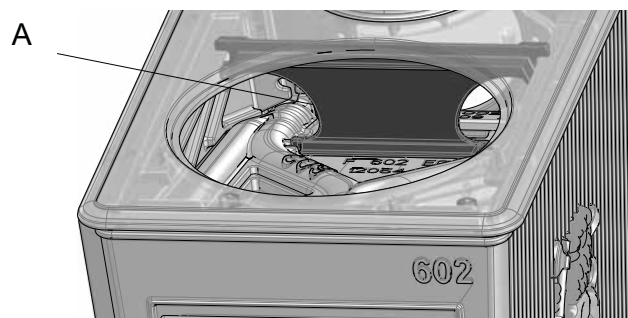
Slika. 28 Zamjena ispušnog deflektora
